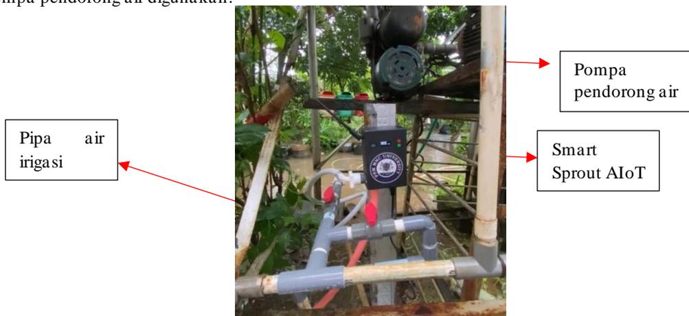
Gambar 5 Pemasangan smart sprout
